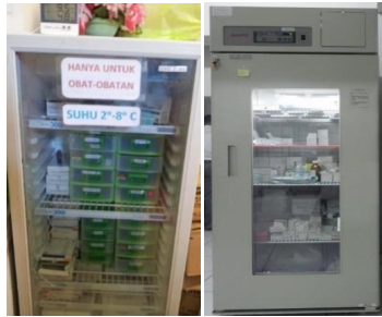
Gambar 1. Lemari pendingin dengan termometer eksternal (kiri) dan lemari pendingin dengan termometer internal (kanan)
